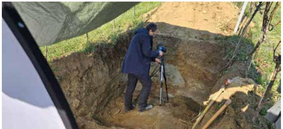
**Das** Digitalisieren eines Bodenprofils ist nicht nur technisch aufwändig, sondern erfordert auch klare Lichtverhältnisse.
