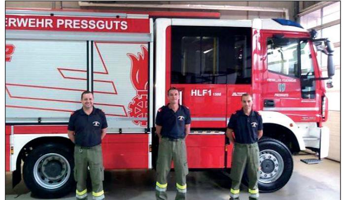
Technische Daten des neuen Hilfeleistungsfahrzeuges der FF Preßguts: 320 PS Automatik mit Allradantrieb, aufgebaut auf einem Fahrgestell IVECO Eurocargo 120-320 mit einem Gesamtgewicht von 12.000 kg von der Firma Magirus Lohr. Mit an Bord des neuen Hilfeleistungsfahrzeuges befindet sich eine Hochdruckpumpe,
